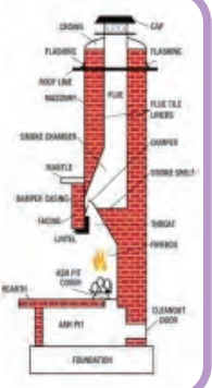
රූපය 1 :- දුම් බටයේ වායුවලින් නික්මෙන අළු (දුඹුලු) අංශු විමිනි නාලය තුළ එක් රැස්වීම නිසා වරින් වර එය පිරිසිදු කිරීම අවශ්‍යය.
