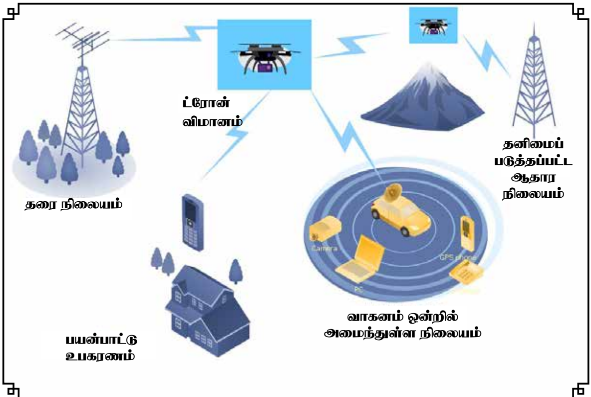
படம் 2 : செலூலர் வலையமைப்பு இணைக்கப்பட்ட UAV ட்ரோன் தொடர்பாடல் வலையமைப்பு
